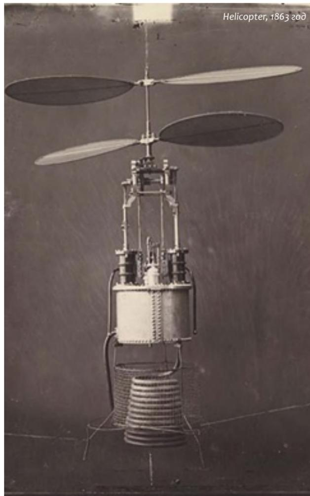
Конструктор подчеркивал необходимость противодействия крутящему моменту горизонтального ротора, приводимого в действие двигателем, и изобрел архитектуру с двумя противоположными роторами.
