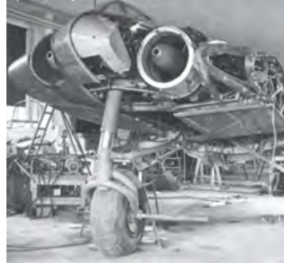
Носовая часть фюзеляжа самолета Horten Ho 9 (Go 229), прототип V-3
