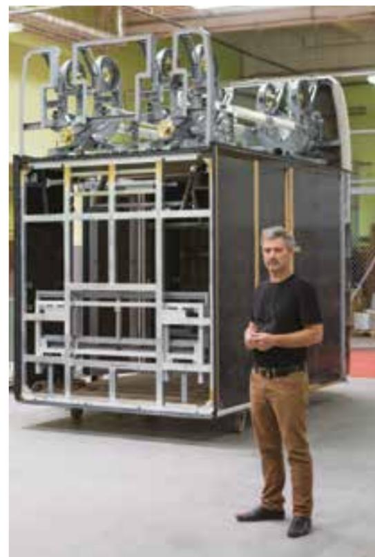
«**Евгений Протасевич, ведущий конструктор:** «При проектировании юнибайка мы отказались от классического металлического каркаса, который потом одевается в стеклопластиковые панели, в пользу монокока – цельного, полностью пластикового кузова. В юнибусе применяется алюминиевый каркас, а также оптимальные легкие и прочные сплавы. А вот в грузовом транспорте уже есть и стальные элементы – это одно из самых нагруженных транспортных средств».
