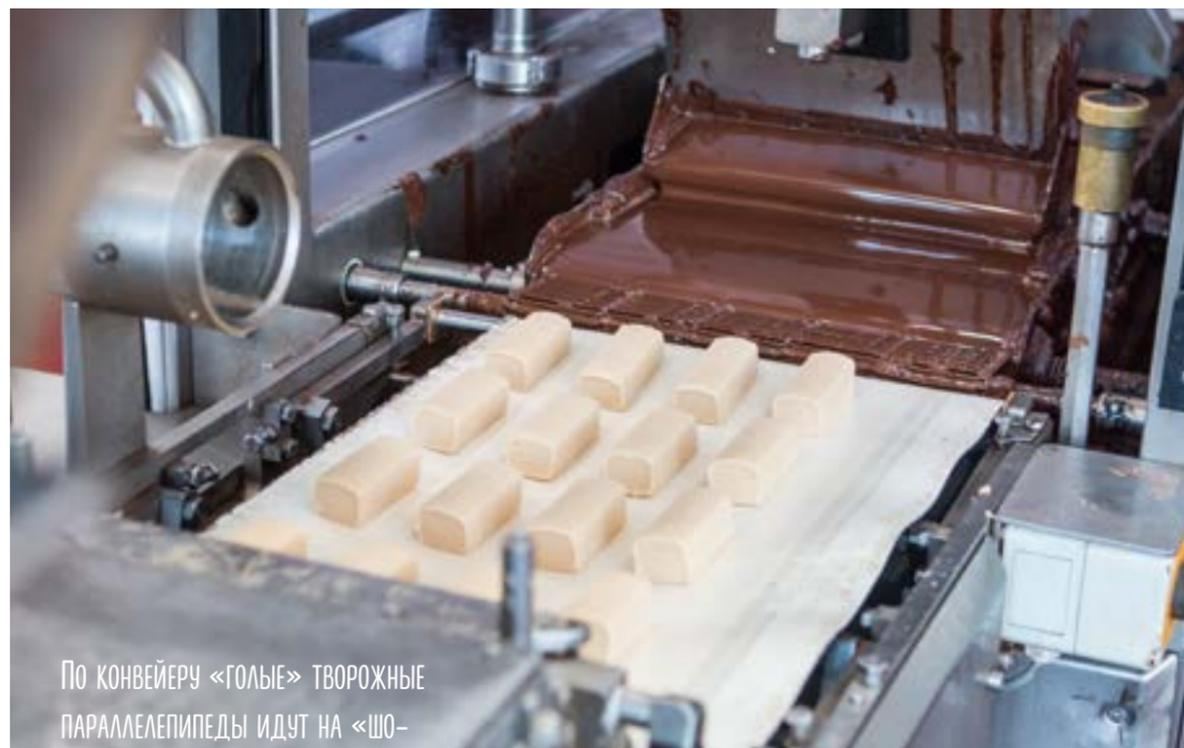
По конвейеру «голые» творожные параллелепипеды идут на «шоколадное обертывание», а после глазирования по транспортеру перемещаются в холодильную камеру, где глазурь охлаждается до твердого состояния.
